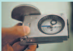
写真3 磁気シールドルーム。この部屋の中ではコンパスは一切機能しない。
