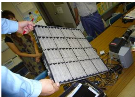
A棟 ゼミナール室 エアコンフィルター詰まり大
